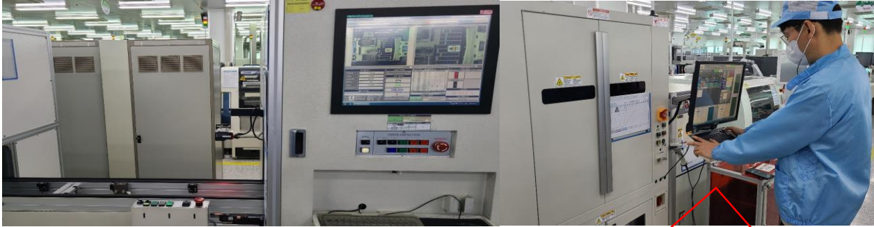
■ 생산 자동화 설비 공정별 & MES 시스템간 PLC 기반 생산 실적 데이터 관리 중
