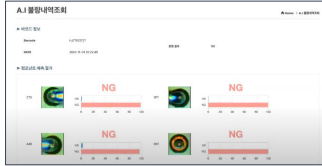
■ AOI검사기 및 IFT검사기 종합 현황관리실 / AI 기반 불량내역 관리 / 진·가성 불량 AI 기반 (AOI 검사 판독) / SMD설비 및 AOI 설비간 인터페이스 현황
