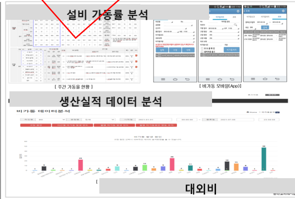
■ MES(POP모듈 포함) 시스템 기반 생산 현장 설비 현황 및 생산실적 통합 모니터링 시스템 구축 운영
