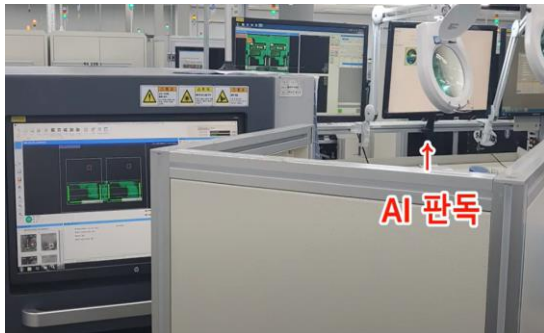
■ AOI검사기 및 IFT검사기 종합 현황관리실 / AI 기반 불량내역 관리 / 진·가성 불량 AI 기반 (AOI 검사 판독) / SMD설비 및 AOI 설비간 인터페이스 현황
